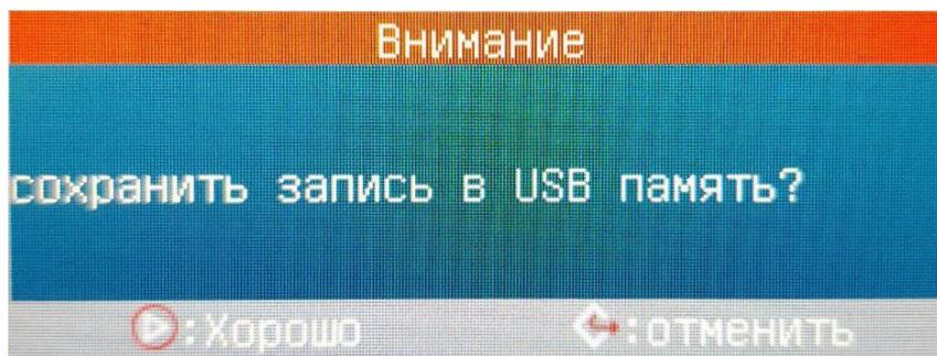
2) Правильно подключите внешний USB-диск в порт USB 2.0 на боковой панели сварочного аппарата, затем нажмите кнопку
