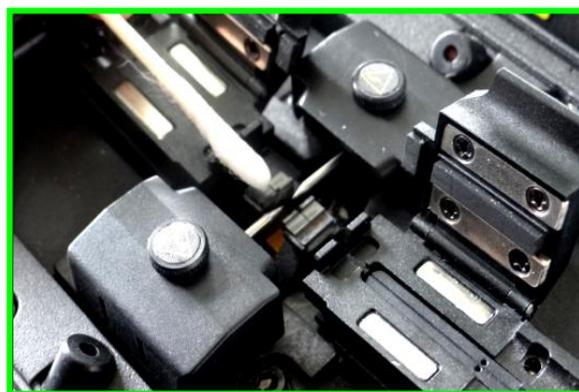
Если тонкие ватные тампоны, смоченные спиртом, не могут удалить загрязнение в V-образной канавке, пользователь может использовать кончик оптического волокна с удаленным слоем покрытия для очистки V-образной канавки. Затем повторите шаг №2.
