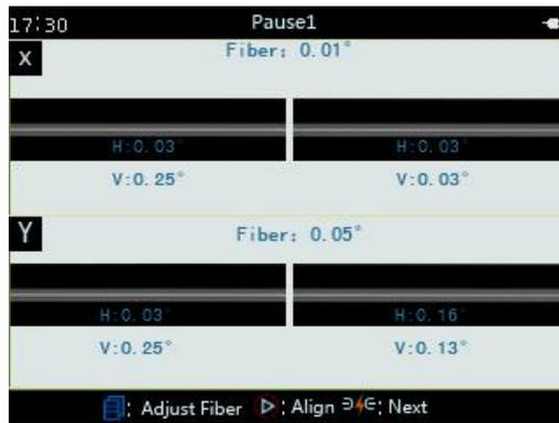
2. В окне операции «Левое волокно» нажмите кнопку или , чтобы переместить X (Y) в левый приводной двигатель вперед или назад. Нажмите кнопку или , чтобы перестить двигатель выравнивания X-поля вверх или вниз.
