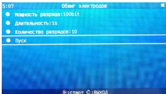
3. Нажмите кнопку
