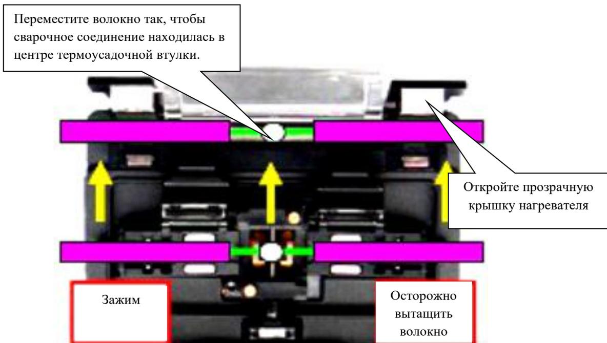
2. Убедитесь, что точка сварки волокон размещена в центре термоусадочной гильзы. Поместите термоусадочную гильзу в центральное положение канавки нагревателя и аккуратно выпрямите волокно. Закройте крышку печи.
