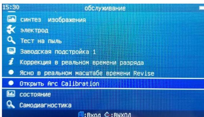
Данная функция позволяет разблокировать «Калибровку разряда» в главном меню сварочного аппарата. Для получения более подробной информации обратитесь к разделу «3.4. Калибровка дуги» данного руководства.
