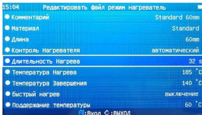
2. При автоматическом режиме управления необходимо поместить сваренное волокно с термоусадочной гильзой в канавку печи и закрыть крышку. После закрытия крышки печь автоматически
