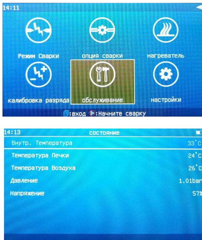
**Примечание:** при работе сварочного аппарата от батареи в правом верхнем углу экрана располагается индикатор -
