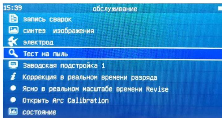
4. Нажмите кнопку
