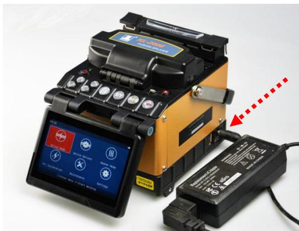
После этого батарея начнет заряжаться, при этом светодиодный индикатор сварочного аппарата будет гореть красным цветом. При полном заряде батареи светодиодный индикатор отключится.
