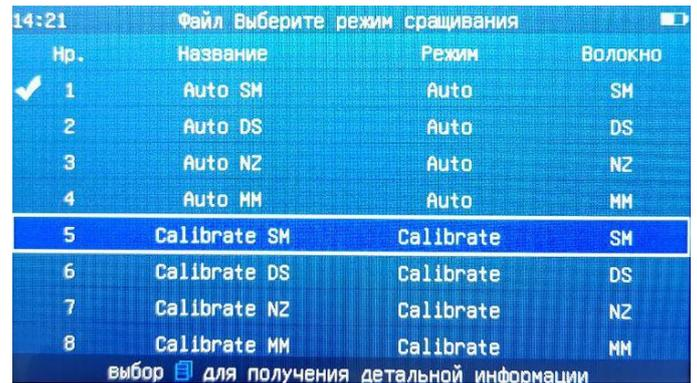
Если требуется добавить функцию «тест на растяжение» в текущей режиме сварки, необходимо изменить параметры режима. Для этого выполните следующие действия:
